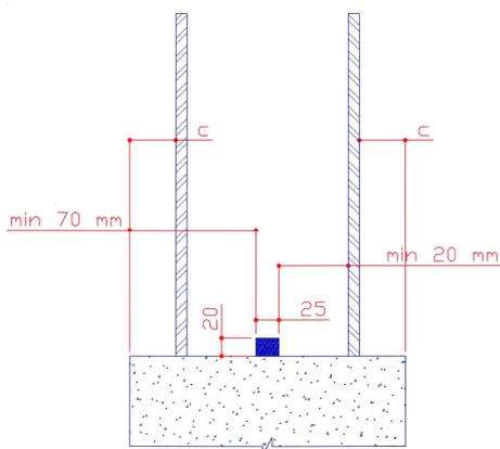
Il fissaggio può essere realizzato per semplice chiodatura del water stop mediante l'impiego di chiodi a testa larga (spaziatura 20 - 25 cm) con l'interposizione, qualora lo si ritenga necessario e secondo le indicazioni della D.L., di rondelle tra la testa del chiodo e la superficie del giunto bentonitico.
